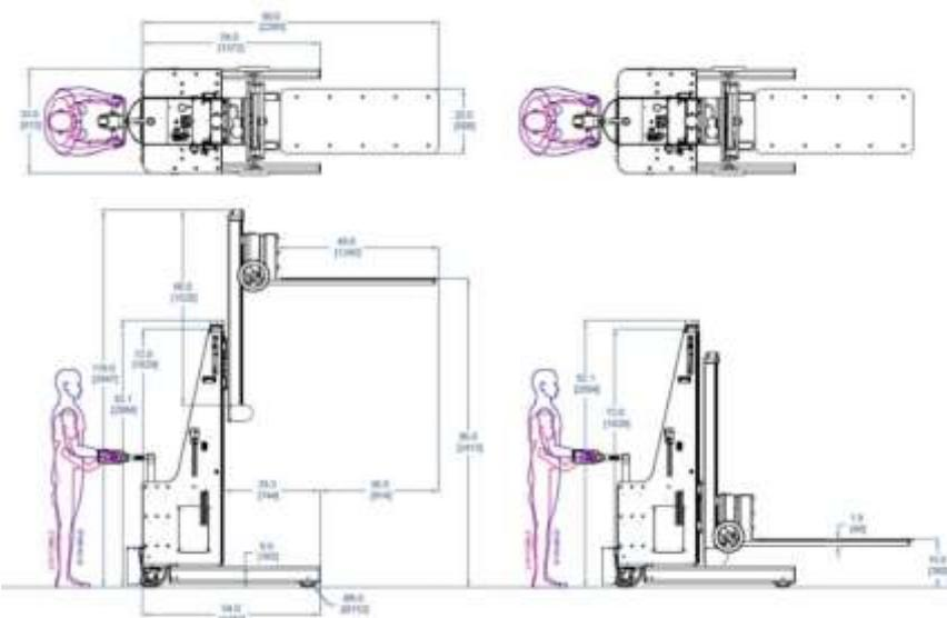
Elektrische Hebehilfe für Laser-Baugruppen mit Teleskopmast, elektrischem Eigenantrieb und spezialbeschichteter Plattform
